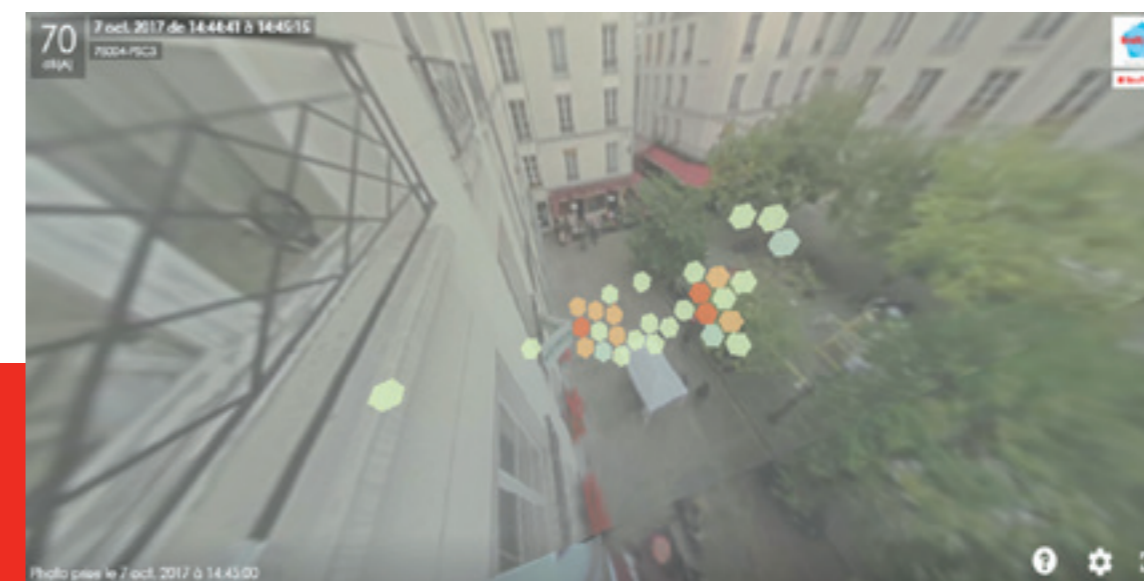
Visualisation de la provenance dominante du bruit sur la place Sainte-Catherine le samedi 7 octobre 2017 à 14h45, réalisée grâce à un capteur « méduse ».
